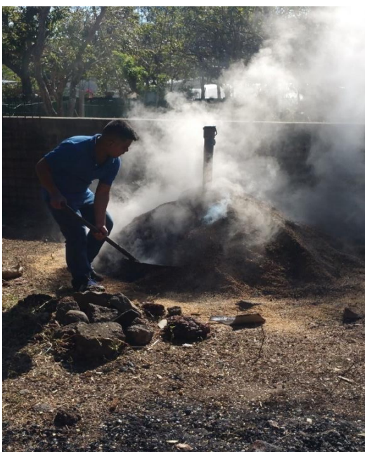
Foto 3. Carbonización de la cascarilla de arroz
