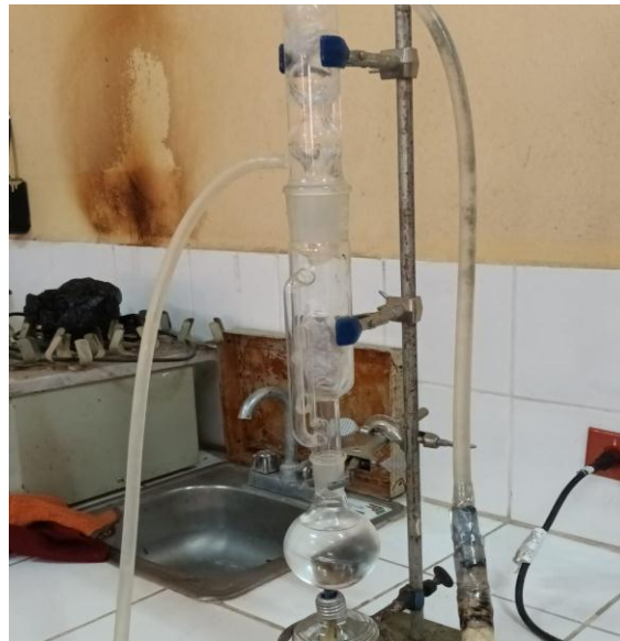
Anexo 5: Procedimientos para la extracción de las soluciones, pesaje de las hojas maceradas (izquierda), montaje del equipo (derecha)
