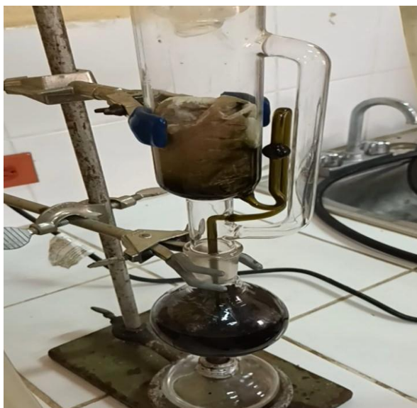
Anexo 6: Extracción de la solución por el método Soxhlet (izquierda), diluciones listas (derecha)
